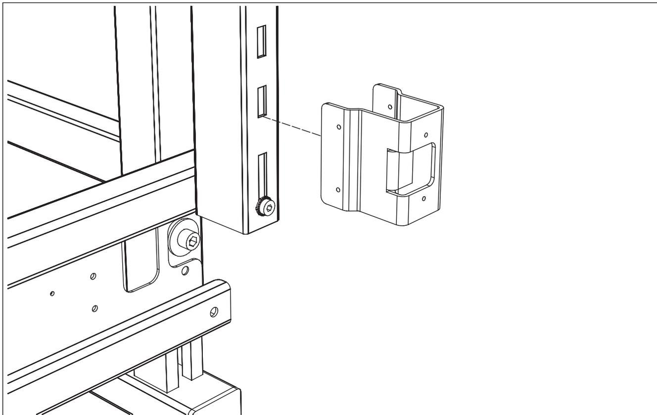
Untere Halterung montieren (Version mit Lochung oberhalb der Tischplatte)
