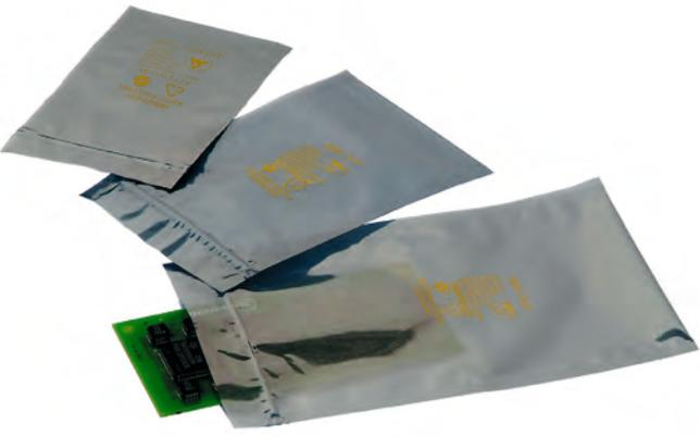
Gefährdete Bauteile und Baugruppen sollten sich für den Transport stets in abschirmenden Verpackungen und Behältern befinden. Gerade außerhalb einer EPA besteht große Gefahr der Schädigung von Baugruppen
