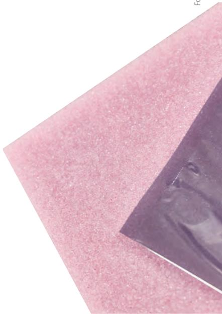
Links ein Polymerschaumstoff und rechts eine mit Aluminium bedampfte Folie. Beide wirken ableitend und sind in der Elektronikindustrie häufig eingesetzte Verpackungsmaterialien
