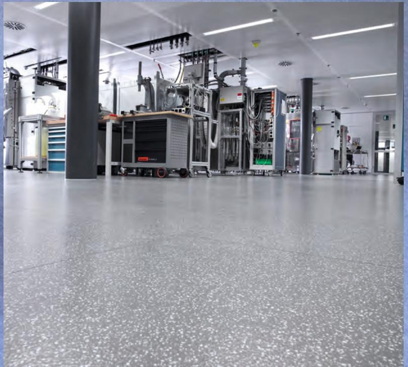
Die Erdung von ESD-Fußböden muss einhundertprozentig gesichert sein. Dafür sorgen die leitfähigen Materialien und die darunter verlaufenden Kupferbänder (rechts zu sehen)
