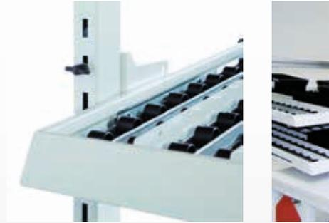
Über geneigte Ablagen, optional ergänzt mit Trennstegen und Röllchenleisten, bewegen sich Behälter selbstständig von der Beschickungsseite zur Entnahmeposition. Materialbereitstellung und wertschöpfende Montage sind voneinander getrennt, gegenseitige Störungen werden vermieden.
