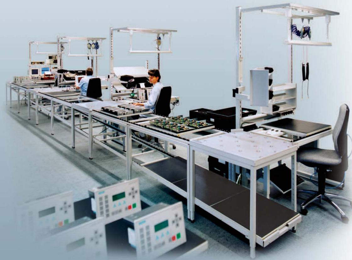
**Transfer- und Logistiksysteme von KARL werden für Transport, Montage und Kommissionierung eingesetzt. Unabhängig von der Produktionsstrategie bietet das Baukastensystem beste Voraussetzungen für einen optimalen Materialfluss. Das Einsatzspektrum reicht von geradlinigen Transferstrecken zwischen Einzelarbeitsplätzen bis zu verzweigten Transferanlagen mit übereinanderliegenden Ebenen für manuelle oder automatisierte Produktionsprozesse.**
